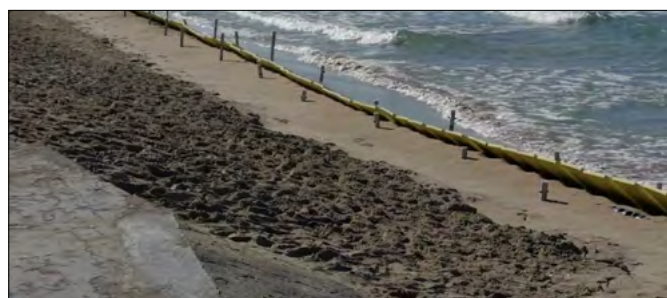
FIGURA 2. Sperimentazione del Sistema Modulare Antierosione lungo un tratto costiero dello storico "Lido San Giovanni" di Gallipoli (LE).
