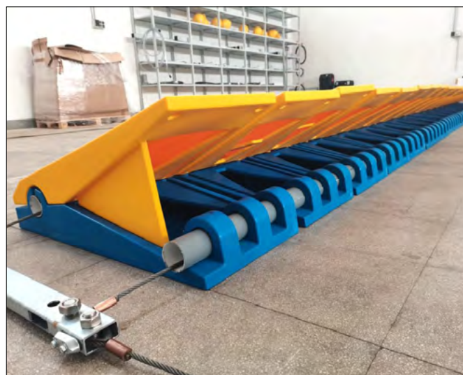
FIGURA 3. Sistema Modulare Antierosione: aspetto della serie di moduli agganciati fra di loro e composti da una base, un'ala con un'inclinazione di circa 20 gradi e due profilati.
